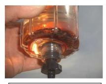
油水分離器の底の方にゴミと水が確認できます。
