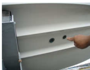
蜂は船底の給排水口から侵入し巣を作ります。
