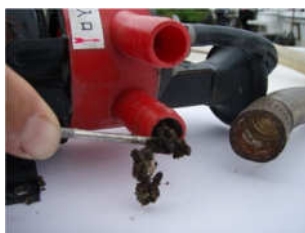
ポンプの経路に、このような土状のものが詰まっています。
