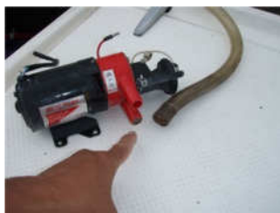
これはトイレの給排水ポンプです。
