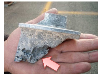
これが電蝕し消耗したアノードです。こうなったら早めの交換が必要です！
