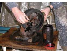
③ 防錆塗装
