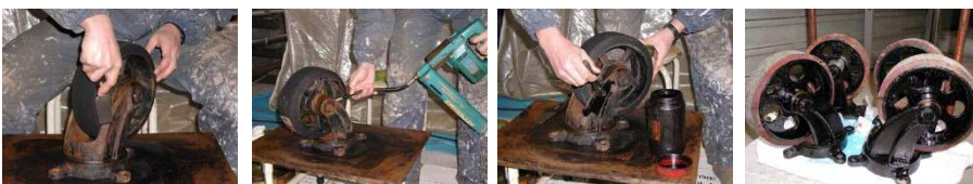
①取外し・錆落とし ②グリスアップ ③防錆塗装 ④完成・取付け
