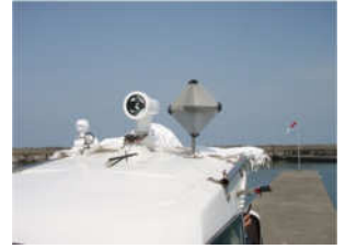
右は自船の存在を相手船に知らせる「レーダー反射器」
