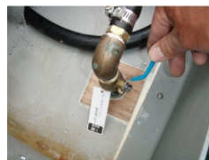
陸上保管中は船底にあるバルブを閉じて下さい。
