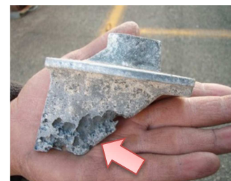
これが電蝕し消耗したアノードです。こうなったら早めの交換が必要です！
