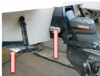
矢印の部分がアノードです。船の金属部が海水に露出した付近に付いています。
