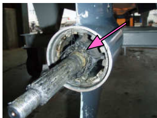
プロペラを外して分かった糸絡み。びっしりと巻き付いています！！
