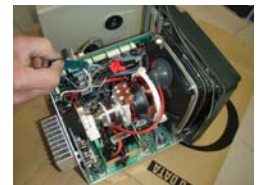
カバーを外すと、中身が詰まっています。指し示している奥に電池があります。
