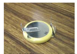
これが内蔵電池です。メーカー推奨の交換時期は3年となっています。
