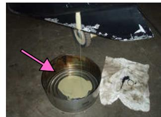
ギアボックス内に海水が混入すると、このようにオイルが白濁し、異常摩耗でギアの破損につながります。
