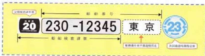
図 2 「実際船に貼られるシール類」 各ステッカーは「船体の両側の外から見やすい位置」に貼り付ける決まりとなっています。
